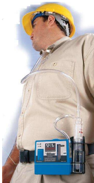
Gorgogliatori con capacità di 25 ml, standard o "bubbler"
