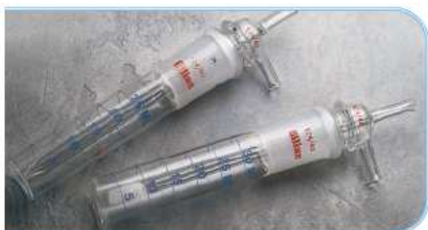
Gorgogliatori con capacità di 25 ml, standard o "bubbler"
