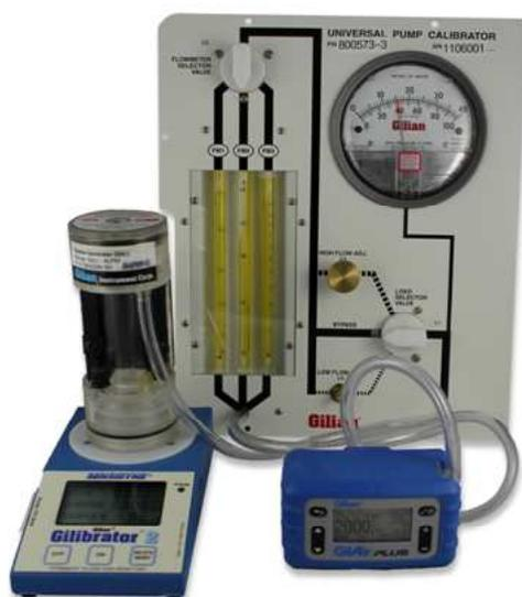
La procedura permette di ricalibrare il sensore della contro pressione misurata. La taratura dovrebbe essere controllata periodicamente, tipicamente all’inizio di un ciclo di campionamento, e comunque non oltre 6 mesi dall’ultima volta.
