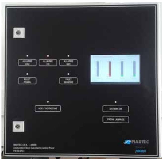
La centrale di rivelazione gas in figura è un dispositivo di analisi che misura la presenza di CO, CO<sub>2</sub> e N<sub>2</sub>O nell'atmosfera, pensata per l'impiego all'interno dei depositi munizioni della navi militari realizzate da Marina Militare Italiana (100 esemplari per le navi in costruzione nel periodo 2017-2022).
