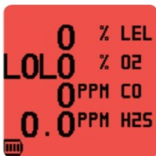
Display rosso in condizioni di allarme
