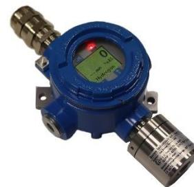
Versione con display e visualizzazione in tempo reale della misura, provvisto di certificazione ATEX; la modifica dei parametri nei menu e delle impostazioni si esegue tramite chiave magnetica, direttamente attraverso il vetro del contenitore.
