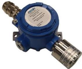
Sensore in contenitore cieco, con uscita analogica 4-20mA; display interno per operazioni di service interno, provvisto di certificazione ATEX.
