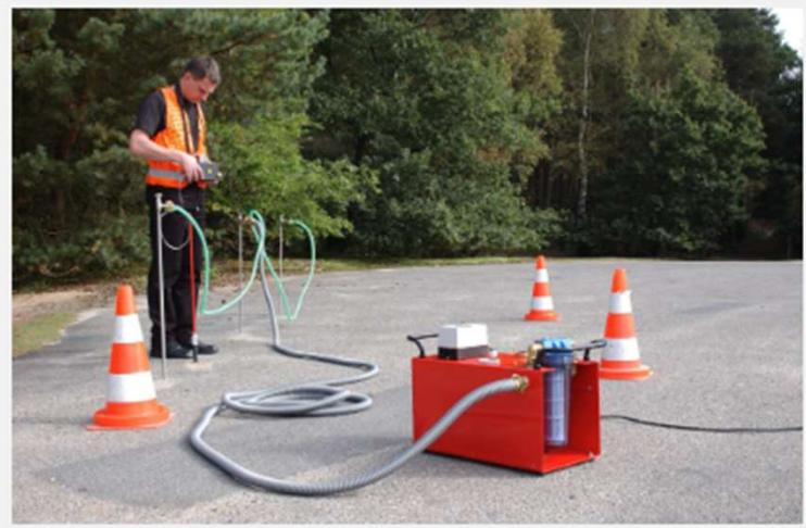
**Laser HUNTER** è un dispositivo per il rilevamento delle perdite e il monitoraggio delle emissioni ad alta precisione e a risposta rapida. Include una tecnologia integrata per la quantificazione delle emissioni e può essere utilizzato in combinazione con il **Vacumobile** per il monitoraggio delle emissioni
